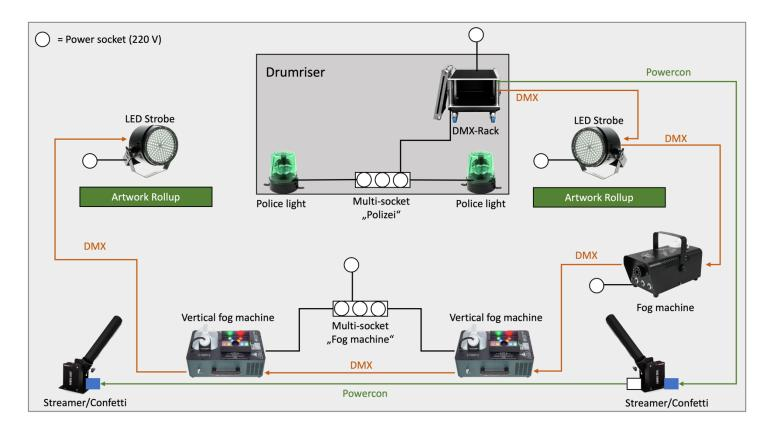
Der obige Plan zeigt den üblichen Aufbau mit der notwendigen Verkabelung. Es werden insgesamt 5 Stromanschlüsse an unterschiedlichen Stellen der Bühne benötigt (DMX-Rack, 2 x LED-Strobe, Fog machine, Vertical fog machines). Die Mehrfachstecker im Plan und die restliche Verkabelung werden von der Band bereitgestellt.
