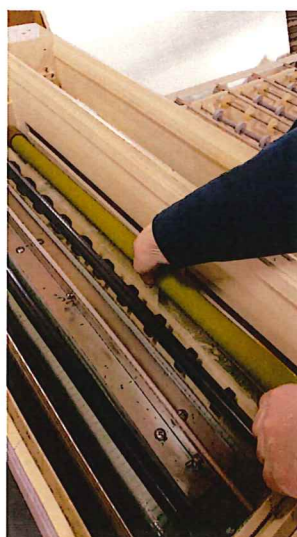
下ローラーの取り付け (平ギア噛ませる)
