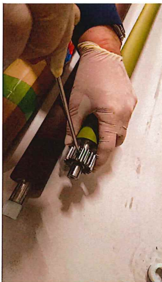
平ギアを新しい ローラーに固定
