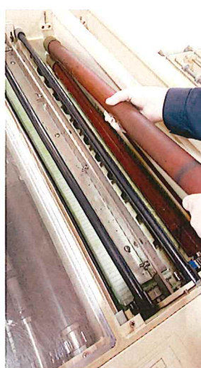
上ゴムローラーの取外し
