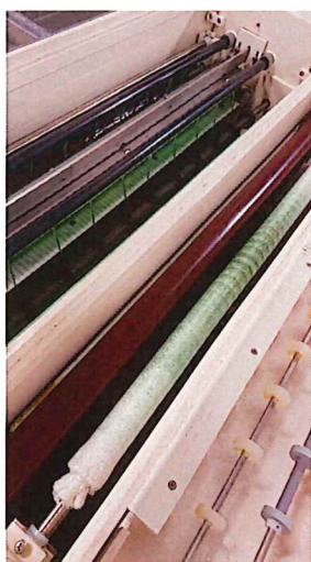
ガム液量を絞る 版面に液が最小量覆っていれば OKです
