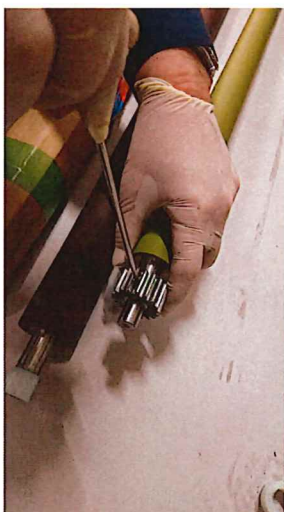
金属の平ギアを新しいローラーに取付け固定します
