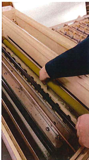
下ローラーの取り付け (平ギアを噛ませる)
