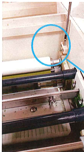
押さえコマに当たる程度に ネジ込む
