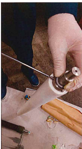
鉄芯にスポンジローラーを取り付けて固定します (SUSカラーのセットネジを締めます)
