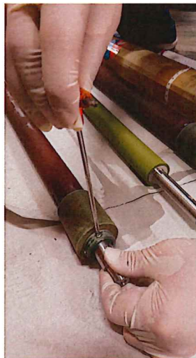
シグナスローラ（スポンジ片）を古いローラーから取り付けます
