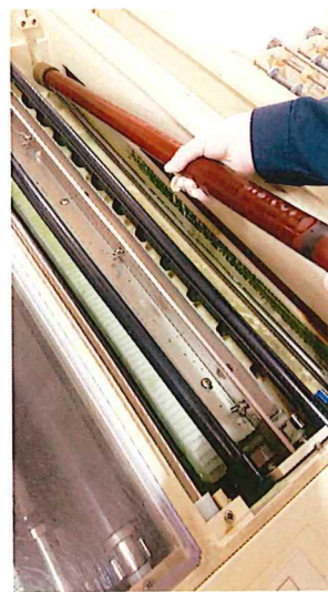
下ゴムローラーの取り外し
