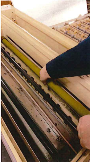
下ゴムローラーの取り付け （平ギアを噛ませる）
