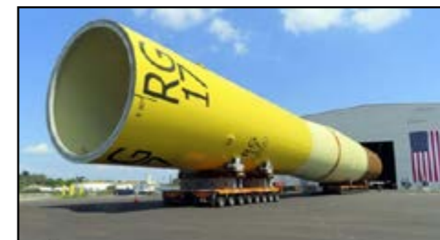
Offshore Windturm wird aus dem Hangar gefahren (die landbasierten Türme haben mit z.B. 16.5 m einen kleineren Durchmesser)
