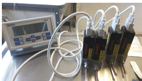
Figure 6 : Dispositif de prélèvement associant un contrôleur et 4 régulateurs de débit massique
