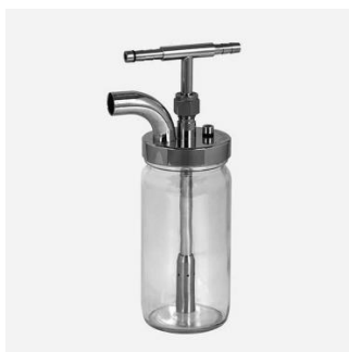
Figure 3 : Générateur pneumatique Collison et schéma de principe
