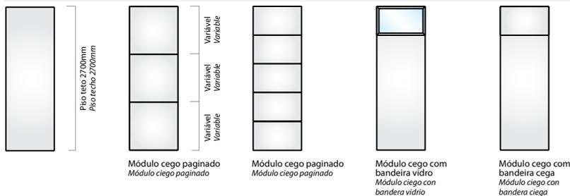
Módulo cego piso teto padrão 900 x 2700mm\*
